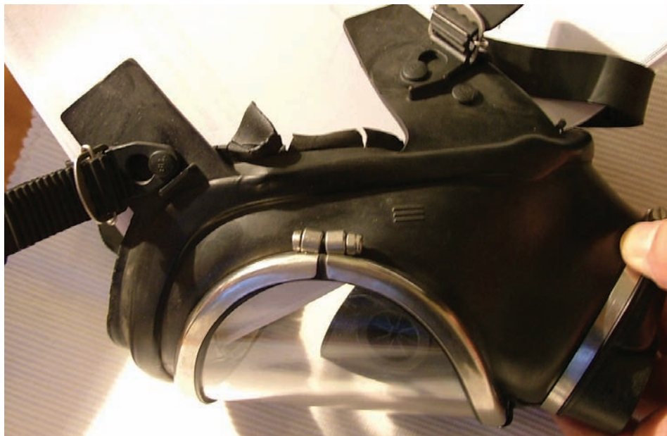
Diese Maske mit zerbröseltem Rand wurde zur Wartung übergeben. Wie man deutlich erkennen kann, ist der Dichtrand tief eingerissen. Das Gummi zerbröselte förmlich.
